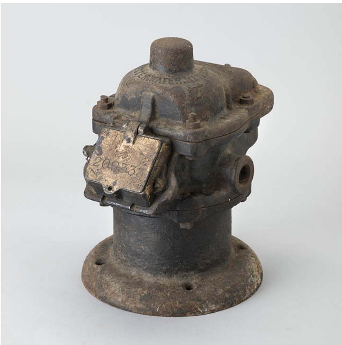
Medidor de agua
