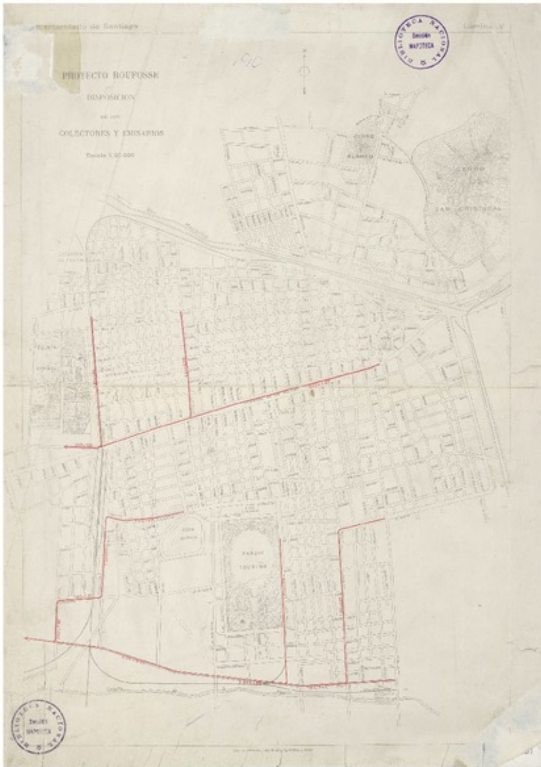
Alcantarillado de Santiago proyecto Roufosse: disposición de los colectores y emisarios. [material cartográfico]:
