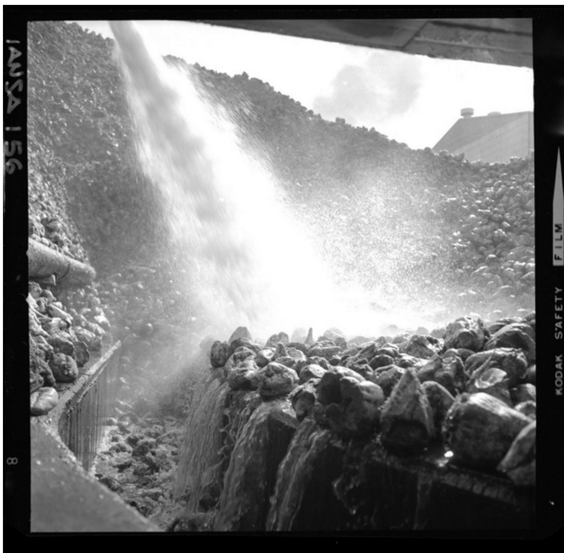
[Iansa (Chile) : Planta Cocharcas : Proceso de lavado de la remolacha] [fotografía] Luis Ladrón de Guevara.
